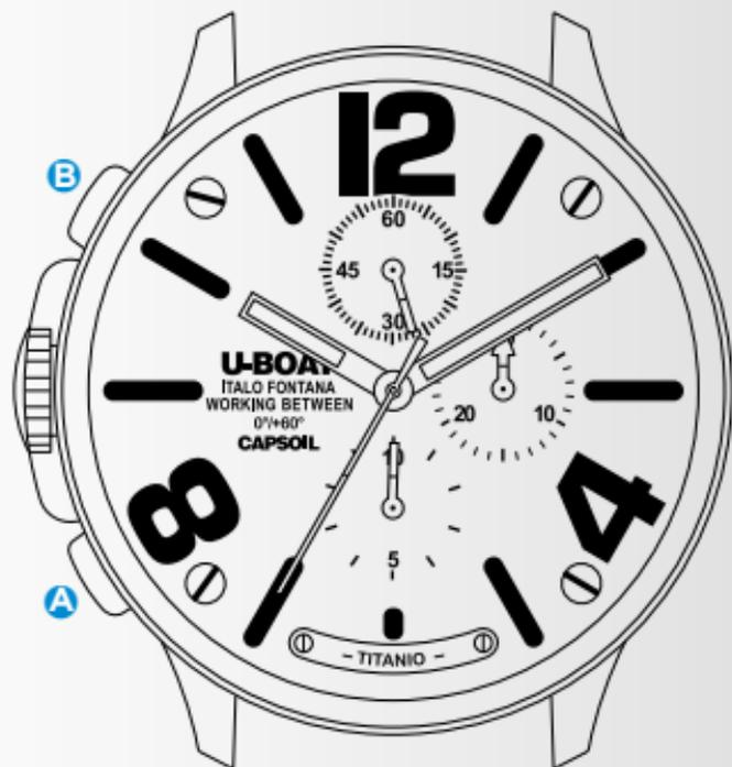
Premere il pulsante **A** (avvio/arresto) per la messa in moto della lancetta del cronografo ed il totalizzatore delle ore/minuti.
