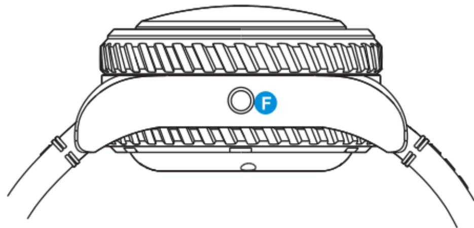
La valvola elio **F** ha la funzione di compensare automaticamente la pressione interna dell'orologio.
